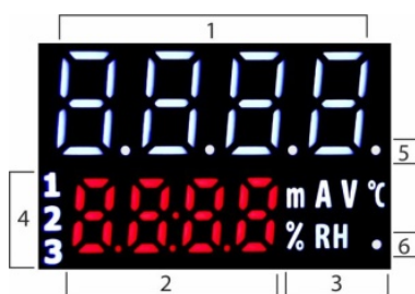
Рисунок 3 – Внешний вид 7-сегментного индикатора
