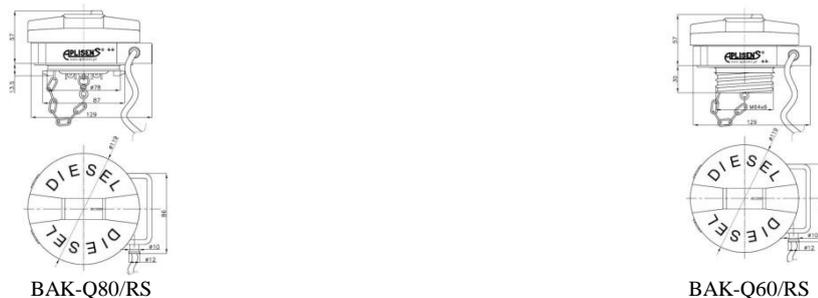
Рис. 1. ВАК-Q80/RS, ВАК-Q60/RS – размеры.
