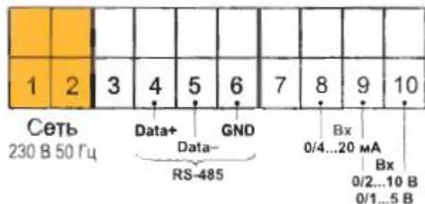
Рисунок 1 – Схема электрических соединений измерителя-регулятора PMS-620TE
