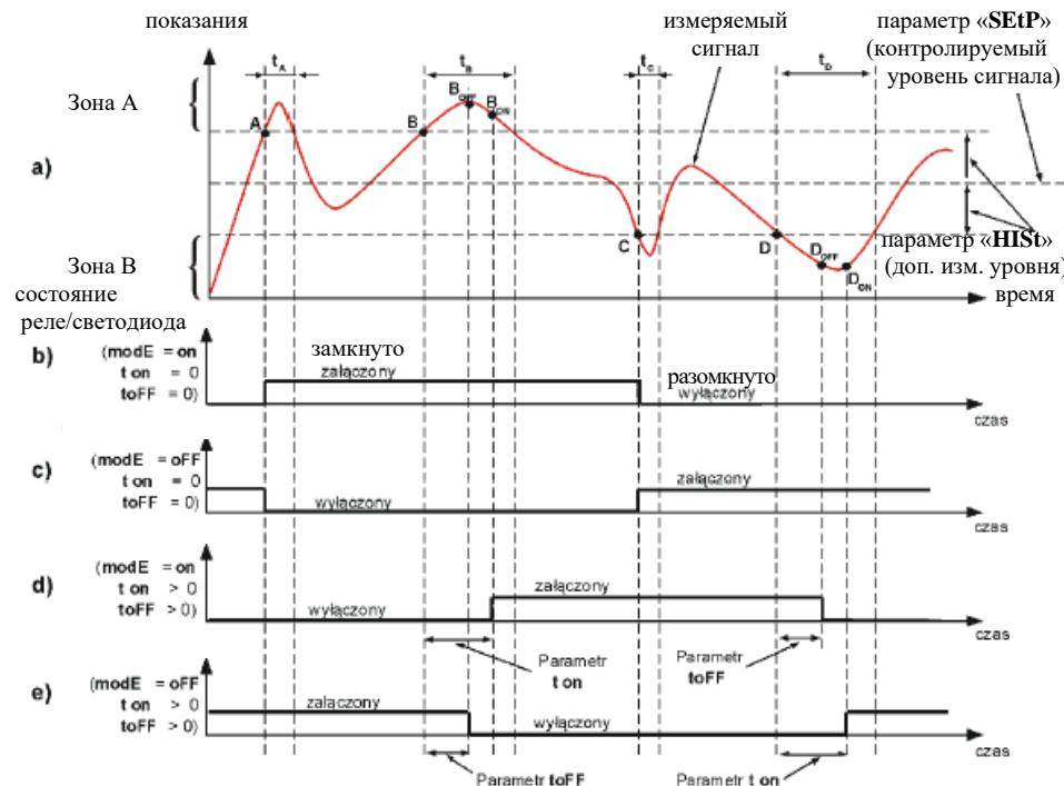
A, D, C, D - точки пересечения граничных значений регулируемого сигнала; B<sub>ON</sub>, B<sub>OFF</sub>, D<sub>ON</sub>, D<sub>OFF</sub> - момент изменения состояния реле/светодиода для случая  $t_{on} > 0$ ,  $t_{off} > 0$ ;
