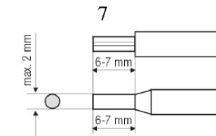
Рисунок 5 - Способ разделки проводов и размеры кабельных наконечников
