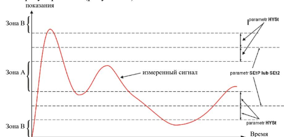
Рисунок 17 - Способ регулирования выходного реле (светодиода) для двух пороговых значений
