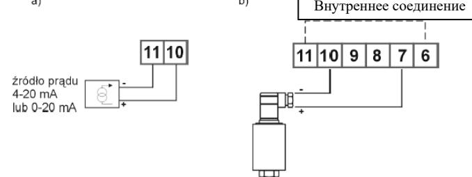
Рисунок 7 – Подключение двухпроводного преобразователя
