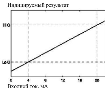
Рисунок 19 - Характеристика прямая ( $\langle\!\langle Lo\ C\rangle\!\rangle < \langle\!\langle Hi\ C\rangle\!\rangle$ )
