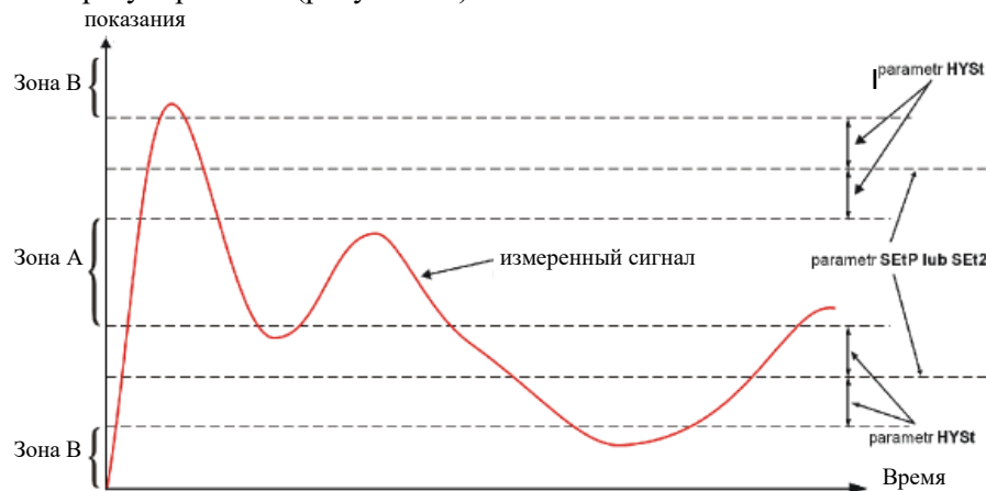
Рисунок 17 - Способ регулирования выходного реле (светодиода) для двух пороговых значений
