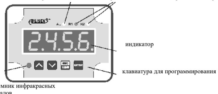
Рисунок 10 – Лицевая панель измерителя-регулятора
