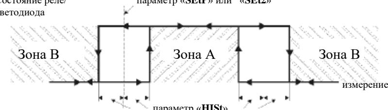
Рисунок 15 - Регулирование по двум порогам релейными выходами R1,R2 (или светодиоды)
