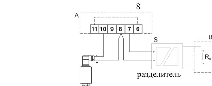
Рисунок 9 – Подключение пассивного преобразователя по двухпроводной цепи с передачей токового сигнала на другое измерительное устройство
