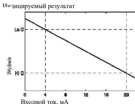
Рисунок 20 - Характеристика обратная ( $\langle\!\langle Lo\ C\rangle\!\rangle > \langle\!\langle Hi\ C\rangle\!\rangle$ )
