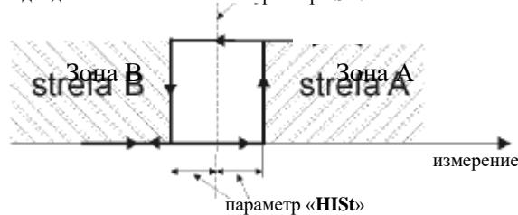
Рисунок 14 - Регулирование по одному порогу релейным выходом R1,R2 (или светодиод)
