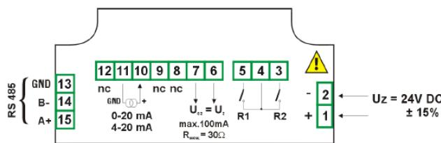
Рисунок 2 – Схема подключений измерителя-регулятора PMS-620N с релейными выходами для исполнения на 24 В постоянного тока
