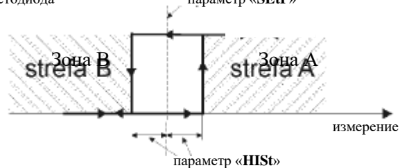
Рисунок 14 - Регулирование по одному порогу релейным выходом R1,R2 (или светодиод)
