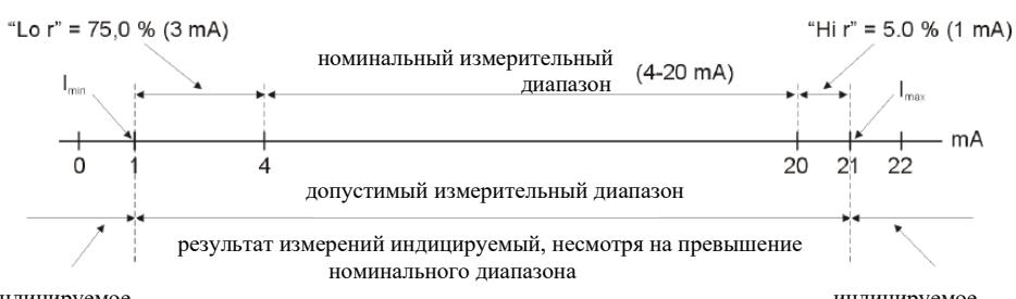
Рисунок 18 - Установка допустимого измерительного диапазона для примера установки параметров «**Lo r**», «**Hi r**» (в режиме 4-20 мА)
