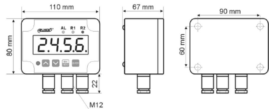
Рисунок А.1- Внешний вид, габаритные и установочные размеры измерителя-регулятора РМС-620 N
