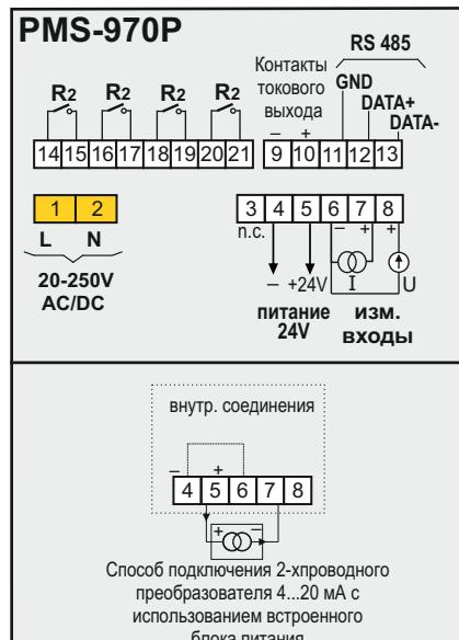
Способ подключения 2-хпроводного преобразователя 4...20 мА с использованием встроенного блока питания
